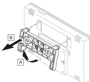
13. Odstraňte závěsnou lištu z regulátoru podle obrázku.
