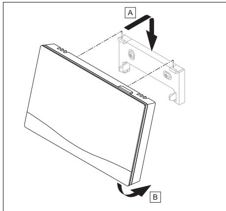
15. Nasadte regulátor podle obrázku na závěsnou lištu, až zaklapne.
