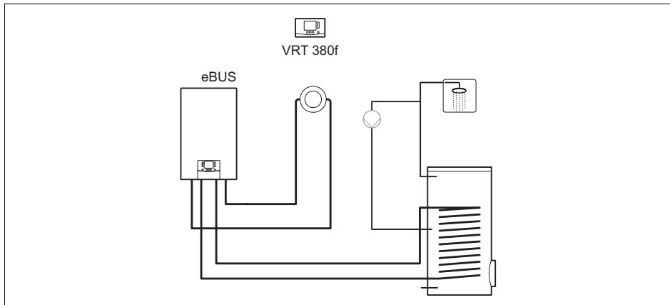
Regulátor se montuje do jednoduchých systémů s přímými topnými okruhy.
